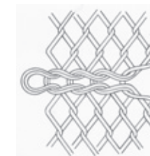
Aflukning af sprang med luftmasker.
